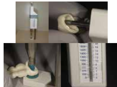
図26 コーヌスクラウン維持力計 (コニメーター) を用いた維持力の測定
