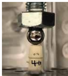
図16 外冠の破折強度試験
